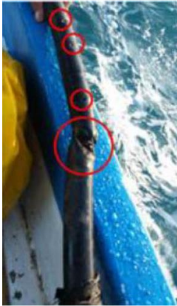
Figura IX.4 Fallas por arrastre e impacto de ancla.
