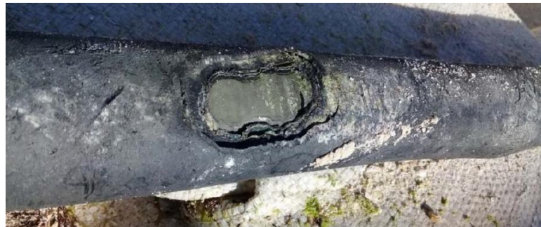
Figura IX.5 Falla ocasionada por propela de una embarcación.
